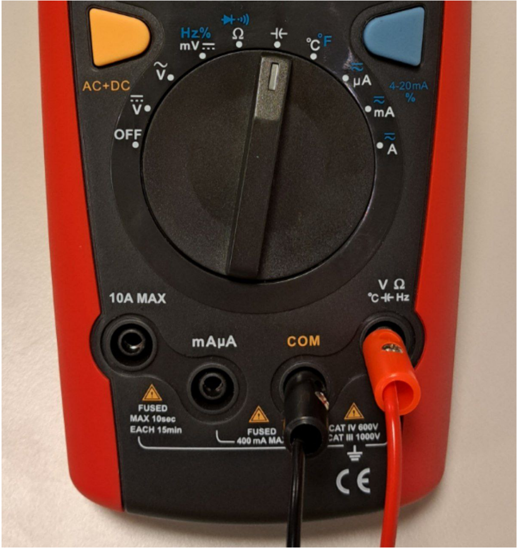
Измерение ёмкости с помощью мультиметра.
